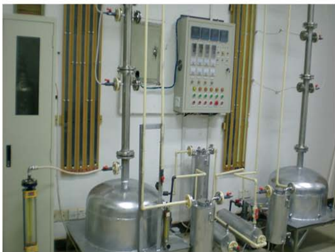
燃煤烟气中SO x 、NO x 和CO 2 污染物一体化脱除试验台
