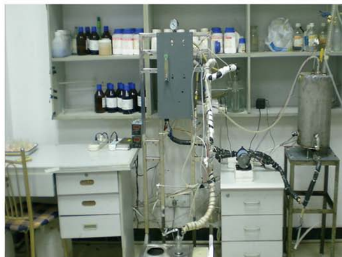
中空纤维膜减压再生实验台
